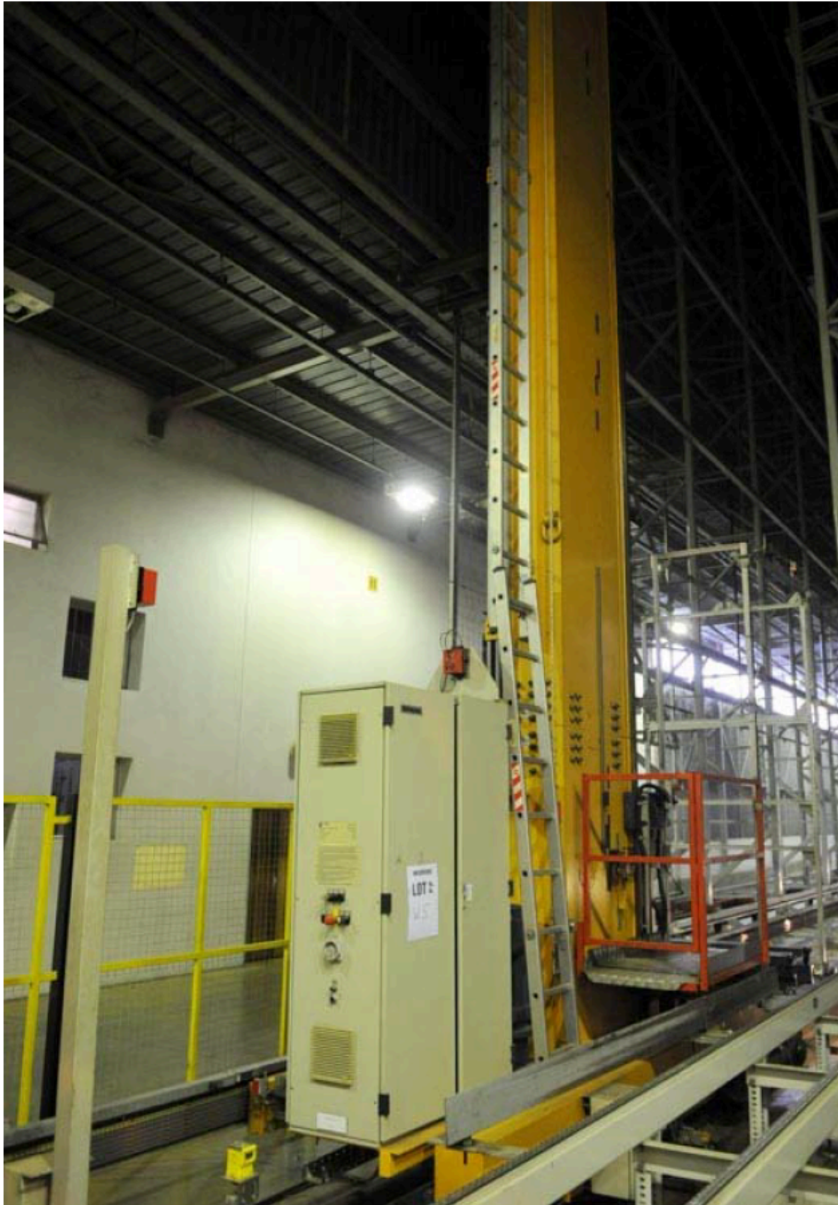
成品仓库（FGS）内的 Demag 起重机，共 3 台相同的起重机。
